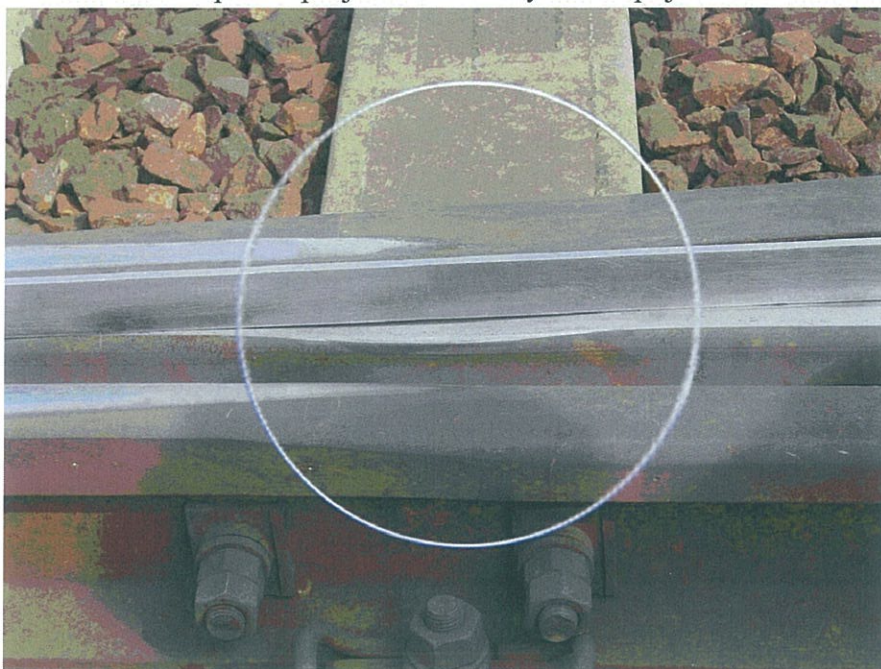
B.4 Podélné a příčné projetí hrotu dle rychlosti poježdění.
